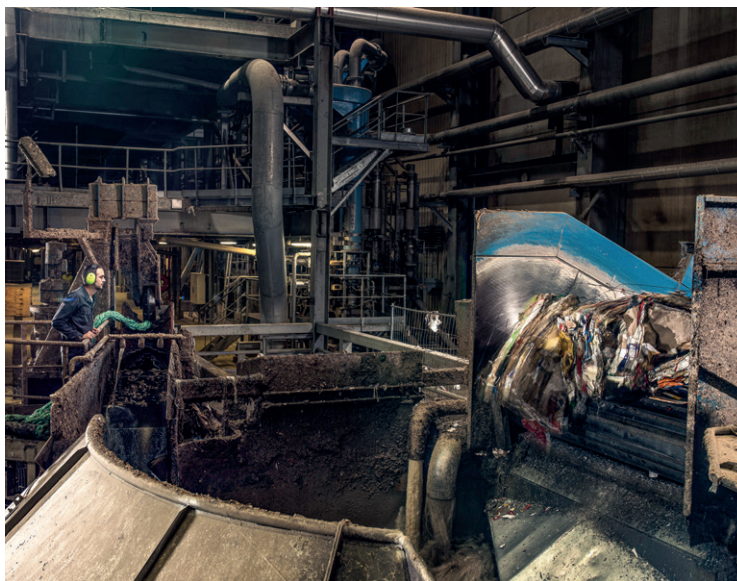
Les papiers à recycler sont introduits dans un pulpeur, qui sépare les contaminants et les fibres de cellulose.
